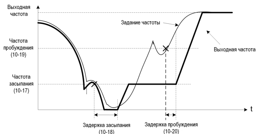
Рис. 4.3.83 (б) Временные диаграммы компенсации частоты «спящего» режима ПИД-регулятора
