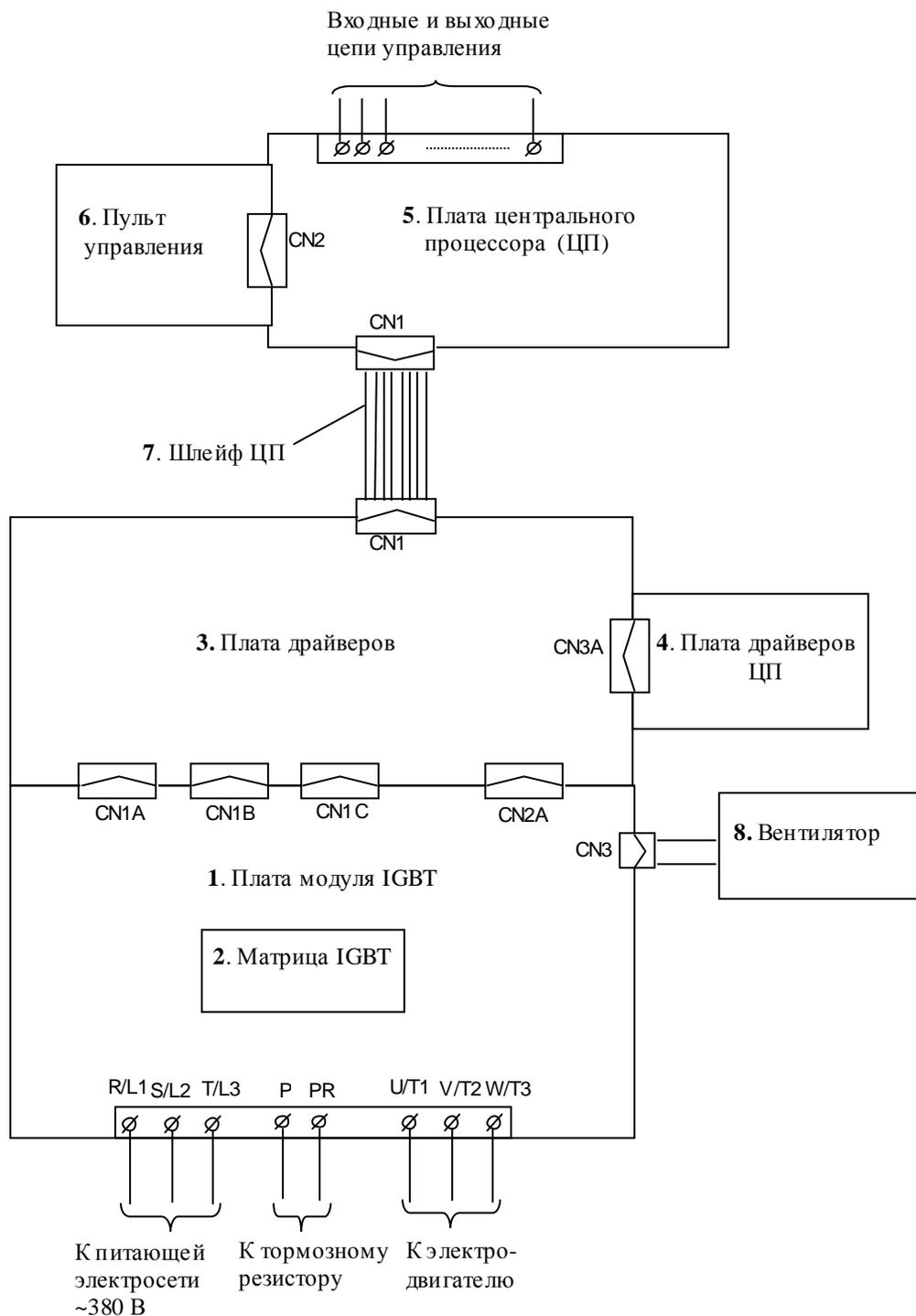
Рис. 4.2. Блок-схема преобразователей частоты Е3-9100-001Н и Е3-9100-002Н
