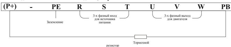
Схема подключения сети питания Модели 1, 2 серии FCI
